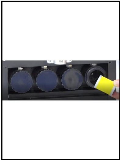
Крышка фильтра откручивается на задней панели; внутри — сменный картридж.
